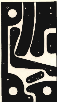
Fig. 2 - Circuito stampato riprodotto in scala 1:1.
